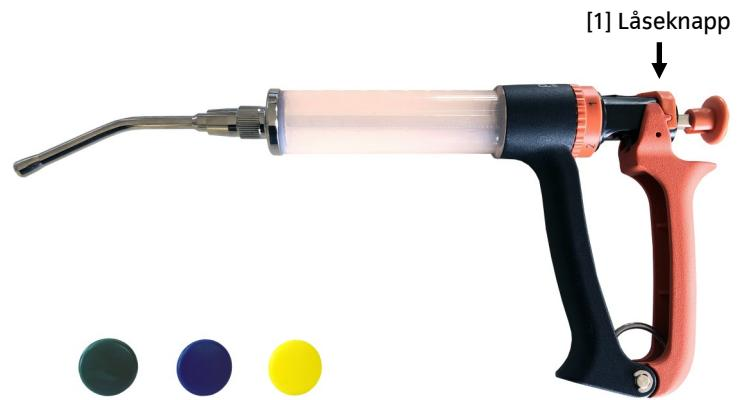
*Prodigy halvautomatisk doseringssprøyte i hardplast, med sylinder i polypropylen og munnstykke i metall. Den oransje knappen på mengderegulatoren kan byttes ut med knapp i grønt, blått eller gult (leveres sammen med sprøya). Sprøya leveres med munnstykke, som må skrus på.*
